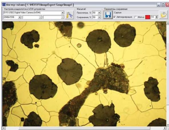
■ **Система ввода изображений.** Анализатор поддерживает как цифровые видеокамеры, так и аналоговые телекамеры с платой захвата (все устройства должны соответствовать стандарту драйверов Windows WDM или TWAIN). Мастер съёмки в программе отображает «живое» изображение структуры образца на экране компьютера, позволяя выбирать поле зрения, настраиваться на резкость и сохранять требуемые кадры в виде файлов изображений для последующего анализа.
