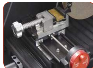
#5-5525 Тиски быстроскользкие со вставками из дельрина для зажима деликатных материалов
