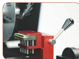
#5-5520 Зажимной адаптер с #15-1045 многоцелевым зажимом
