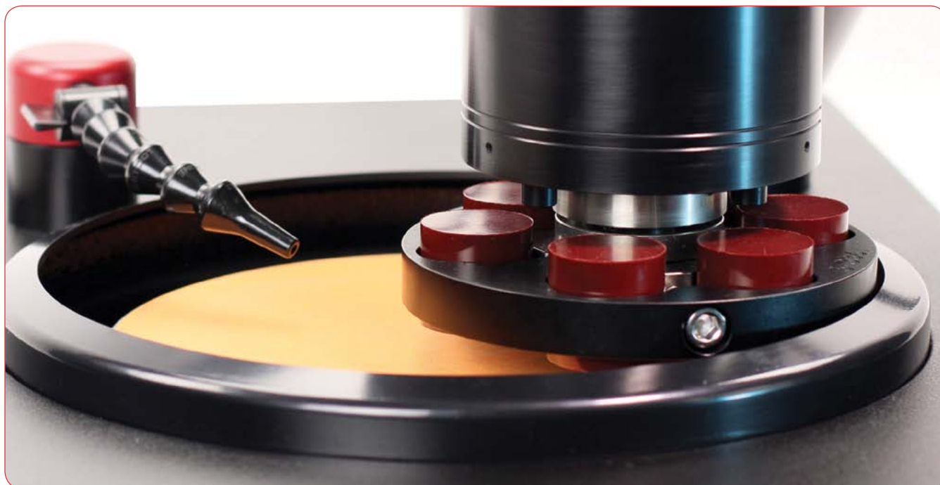
PH-3™ в режиме центральное усилие: один силовой поршень создает усилие для макс 6 запрессованных образцов
