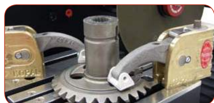
#5-5330 Стол с Т-образными пазами для различных типов зажимов Показано с тисками для вертикального зажима #5-4050
