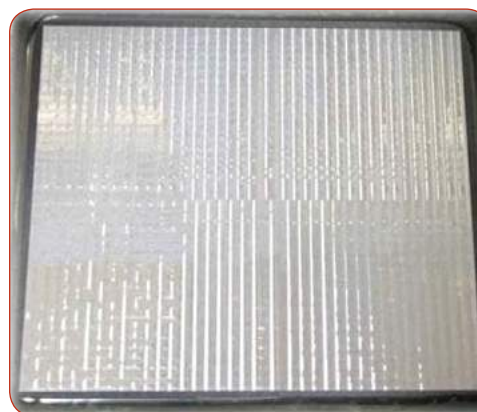
Разборка микросхемы по профилю обеспечивает равномерное удаление материала
