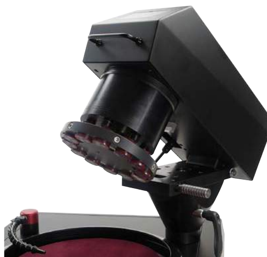
Удобное откидывание насадки для легкого доступа к рабочему кругу и держателю образцов
