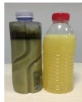
Сравнение СОЖ до и после очистки
