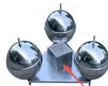
Сетка грубой очистки
