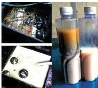
Сравнение СОЖ до и после очистки
