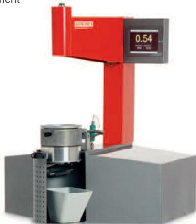
Единственный в своем роде прибор, позволяющий производить испытания в полностью автоматическом режиме, при помощи камеры, фиксирующей первый пузырек и интеллектуальной системы анализа изображений.
