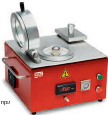
Для изготовления образцов при настраиваемом вакууме.
