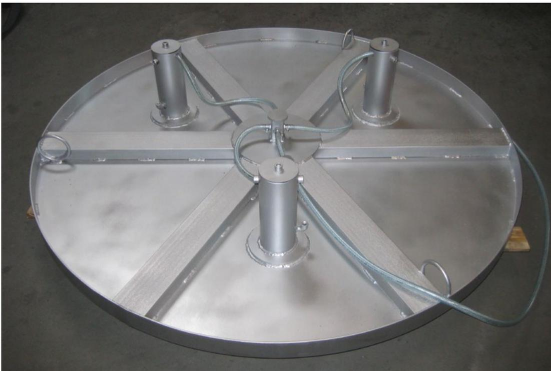
При наличии нескольких печей разных размеров возможно уплотнение печей с помощью одного комплекта донных плит. Для этого одна плита для печи наименьшего диаметра оснащается одним или несколькими пневматическими вибраторами, а остальные плиты для печей большего диаметра соединяются с первой плитой без особых усилий с помощью быстросъемного крепежа.
